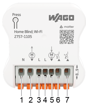
Abbildung 4: Anschlüsse (Abbildung ähnlich)
